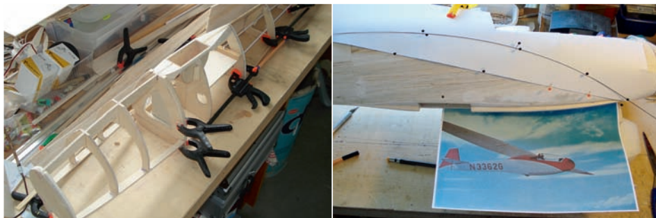
Bild 4: Das Ergebnis kann sich sehen lassen, die Spanten passen perfekt. In diesem Zuge wurde auch gleich der Hauptspant korrigiert · Bild 5: Auch die Schneideschablone für die Folienbespannung ließ sich auf diesem Wege anfertigen.
